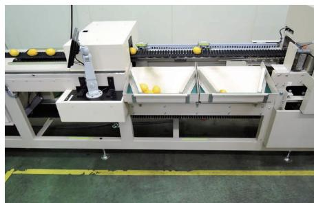
(株)メディカル青果物研究所は大手光学機器メーカーと共同で、レモン中腐検出装置を開発しております。レモンを破壊することなく、光を当てて中腐れを検出できる仕組みとなっており、1時間で2,000個の検品が可能。現在一部の法人様で出荷しているレモンは、全てこの機械で検品しております。産地の切り替えも考慮し、今後も検証を続ける予定です。
