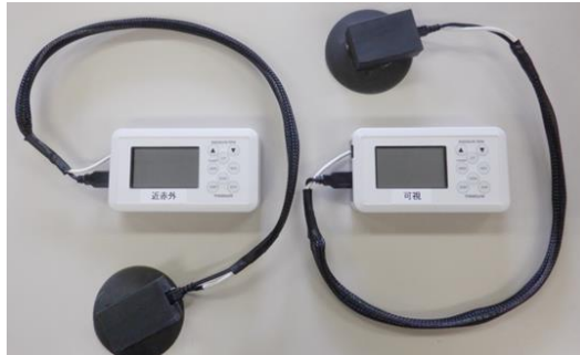
図 1. ハンディタイプのキャベツ鮮度センサー
